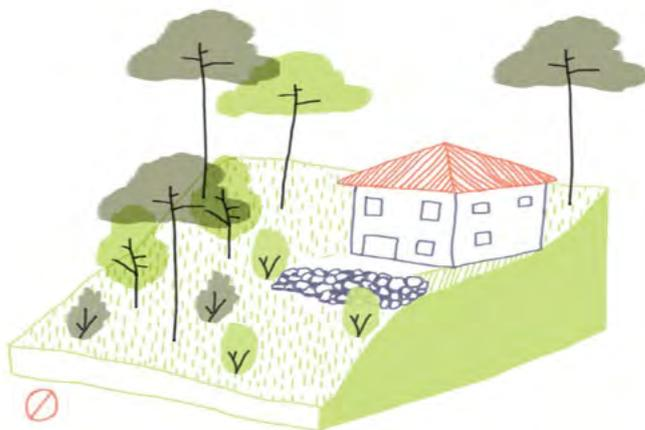
La modification trop brutale du relief et l'usage d'enrochement en soutènement dénature le site.
