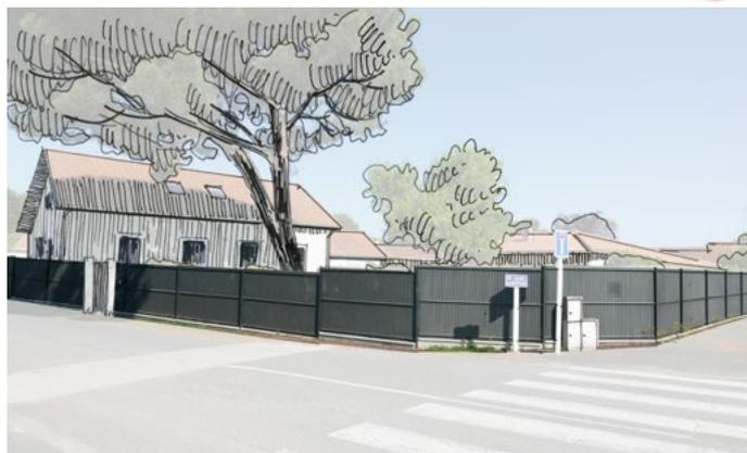
Exemple de clôture treillis soudée à proscrire : avec remplissage opaque de lames PVC et soubassement béton (d'aspect industriel et défavorable à la petite faune)
