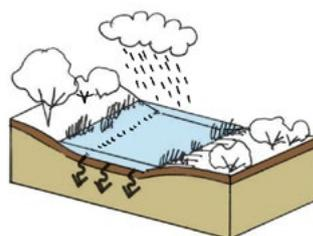
Noue d'infiltration naturelle en terrain perméable
