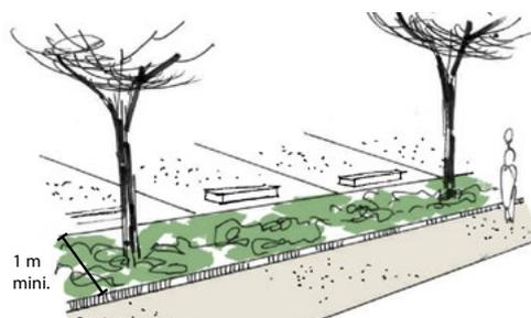
Schéma d'une bande plantée en espace contraint (entre parking et cheminement piéton) où on peut réduire la largeur à 1 m minimum si la fosse est continue
